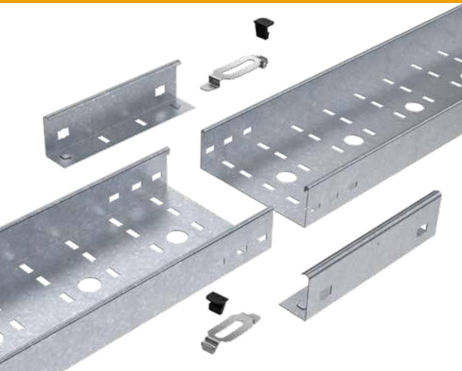
Este sistema permite la unión de tramos con una novedosa PLACA DE UNIÓN ENVOLVENTE Y AUTOPORTANTE, más resistente y segura, la cual se acopla con un CLIP, sin necesidad de herramientas ni bulonería.
